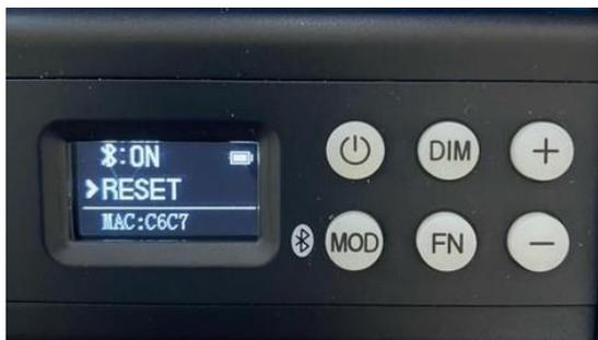
「FN」ボタンで上下切り替え、「+」「-」ボタンでON/OFF及びRESETです。Bluetoothを「ON」にします。
